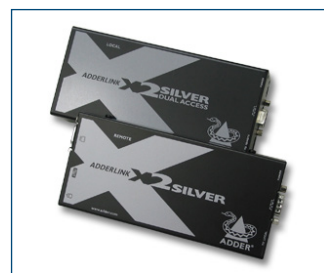
El extensor de KVM opcional permite colocar el monitor a una distancia de hasta 300 m del ordenador.
