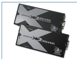
El extensor de KVM opcional permite colocar el monitor a una distancia de hasta 300 m del ordenador.
